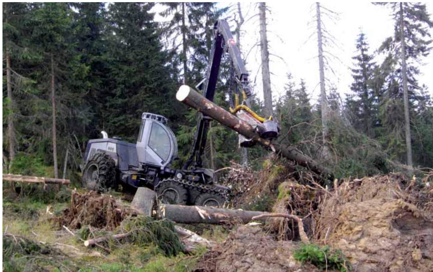
Obr. 11: Při plošném napadení porostů kůrovcem či rozsáhlým polomům se používají harvestory. Foto: Franz Baierl
